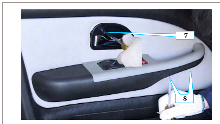
图10-42 拆车门内拉手、门护板开关面板
