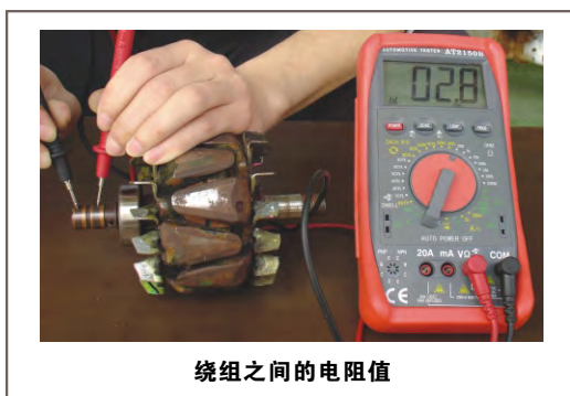
图10-4 转子绕组检查
