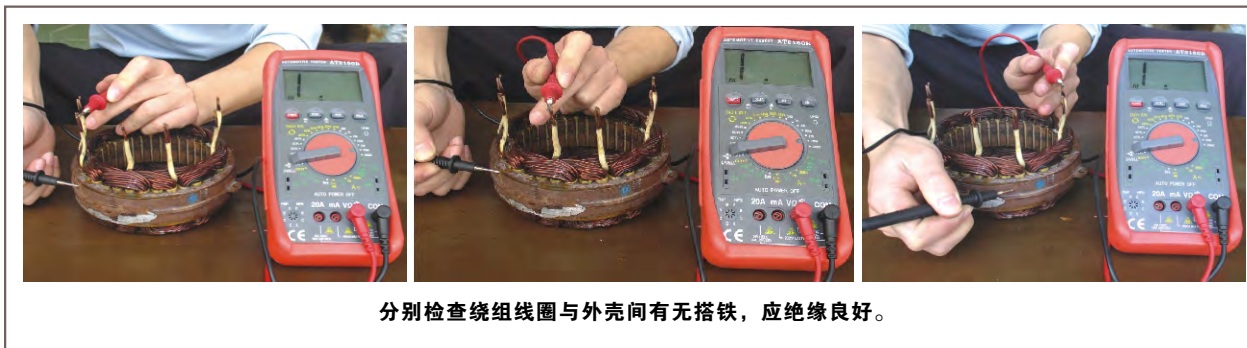
图10-5 电枢绕组搭铁的检查
