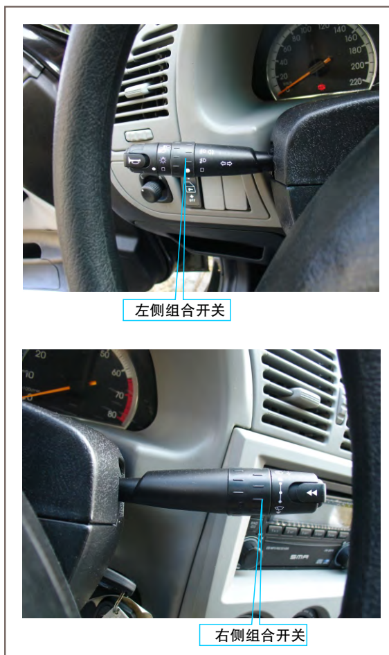
图10-29 组合开关安装位置
