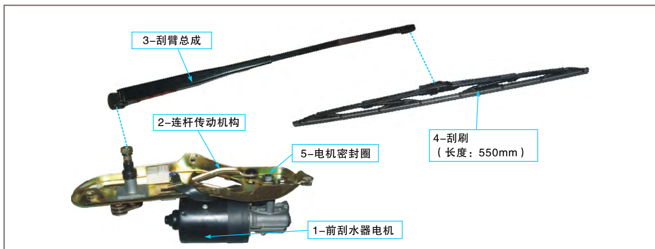
图10-33 前风窗玻璃刮水器分解
