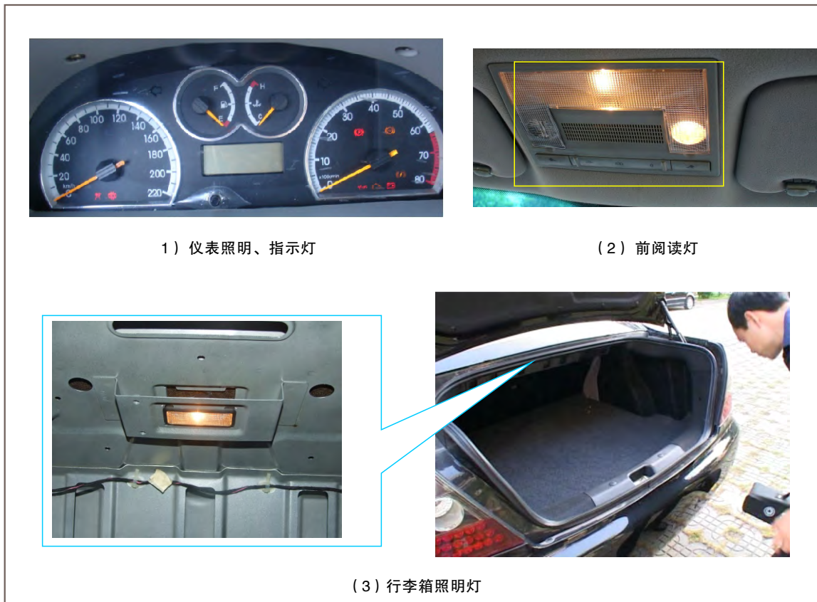
图10-12 内部照明及信号装置
